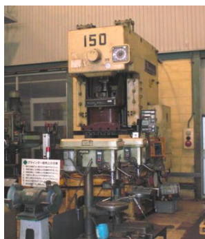
トライ用プレスとして活用する 金型修理の精度アップ 及び大幅な時間短縮が 図れる
